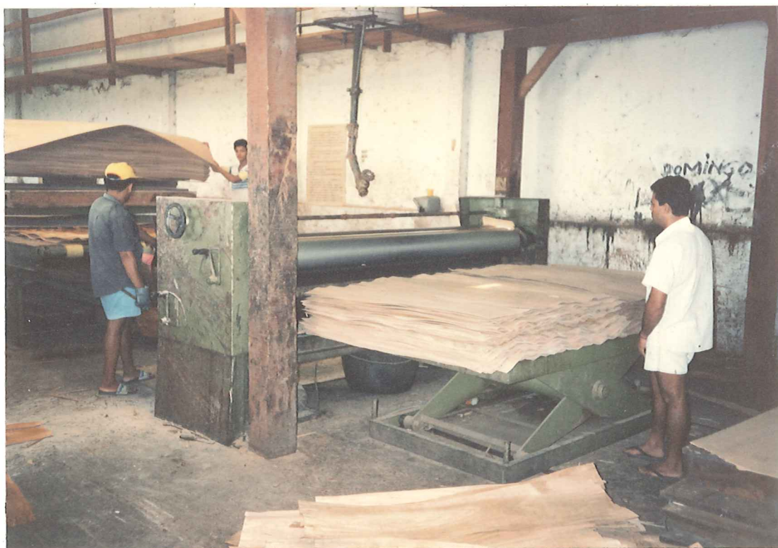
Foto nº 25 - Montagem dos Sanduíches (Passadeira de Cola) - KARSON/Xinguara
